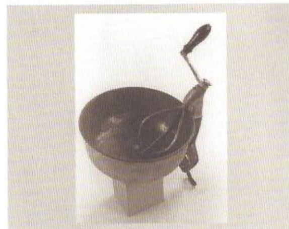
Foto 3: Mengkom met roerder (Begijnhofmuseum, Turnhout). Kom om bloem en water tot hostiedeeg te mengen: inhoud 4 liter. Deze mechanische roerder werd met de hand bediend en met een spanvijs vastgeklemd op de tafelrand. Vermoedelijk in gebruik rond 1935.
