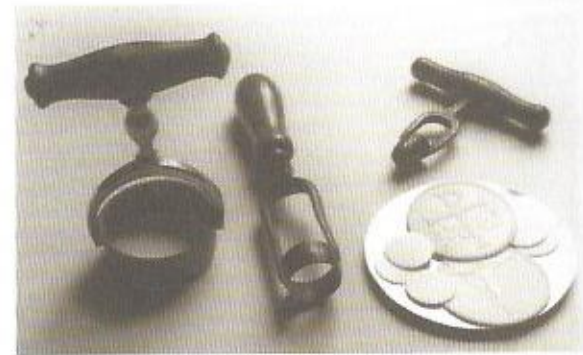
Foto 10: Steekijzer voor grote en kleine hosties. Bemerkt rechtsboven het "oorlogsmodel 1914".
